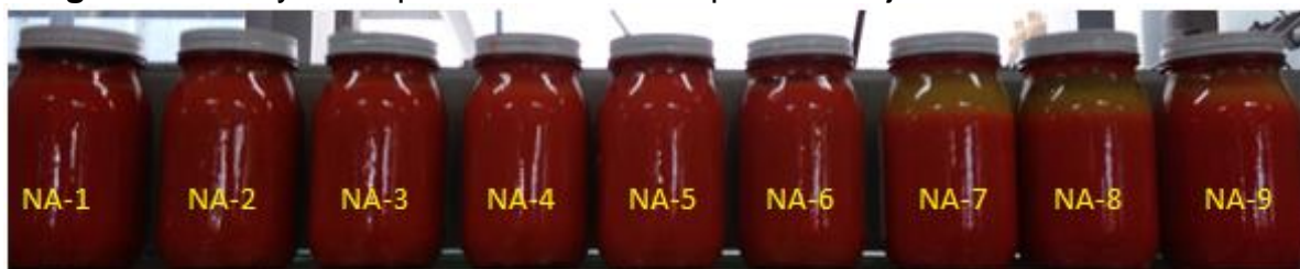
Imagen 21. Ensayos después de estabilidad para Naranja Molibdeno
