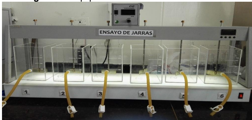
Figura 12. Equipo de Prueba de Jarras automática
