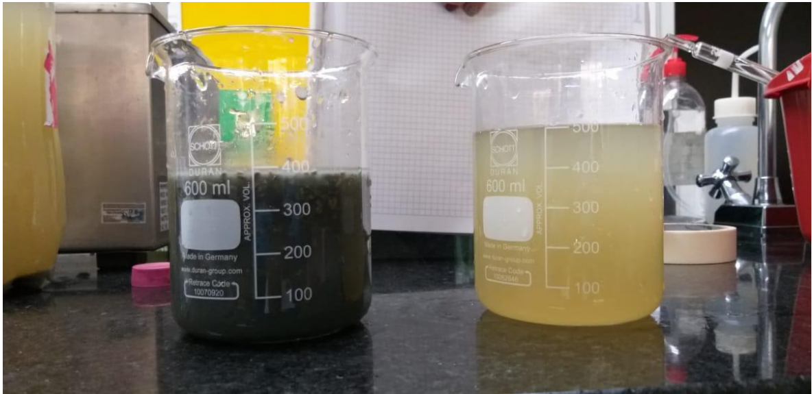
Figura 14. Aguas antes y después de la trampa de grasas
