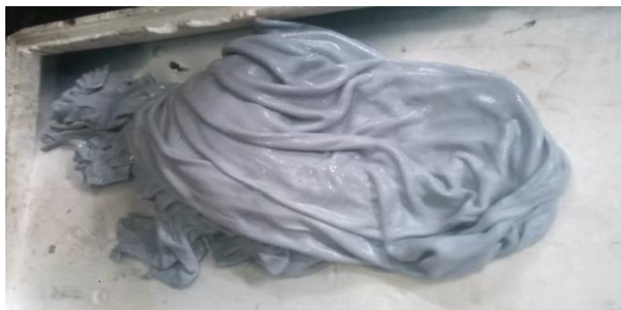
Figura 7. Pieles obtenidas del Piquelado y Curtido
