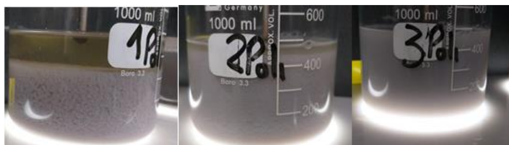
Figura 25. Proceso de coagulación con 200, 400 y 600 Mg/L de policloruro de aluminio
