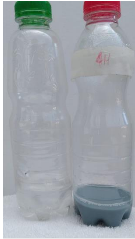
Figura 19. Separación de la torta y el sobrenadante del proceso de sedimentación con concentración de hidróxido de sodio 159.988 Mg/L.
