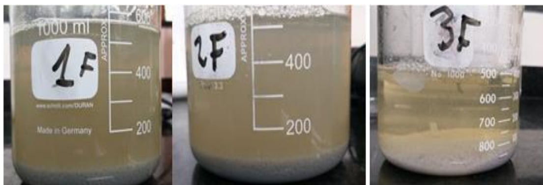
Figura 24. Proceso de floculación con 20, 40 y 60 Mg/L de poliacrilamida
