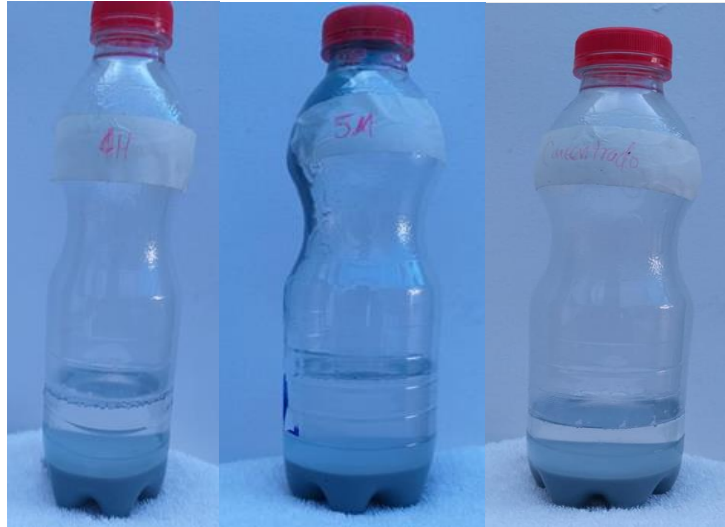
Figura 18. Proceso de sedimentación del cromo con concentración de hidróxido de sodio 159.988 Mg/L.
