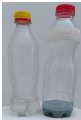
Figura 21. Separación de la torta y el sobrenadante del proceso de sedimentación con concentración de hidróxido de sodio de 980.000 Mg/L
