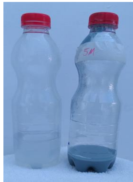
Figura 20. Separación de la torta y el sobrenadante del proceso de sedimentación con concentración de hidróxido de sodio 199.985 Mg/L
