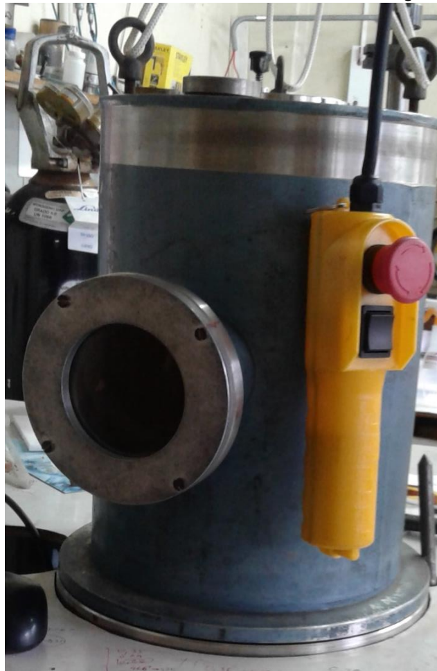
Figura 20. Evaporador reactivo de ZnO, Universidad Nacional de Colombia sede Bogotá.
