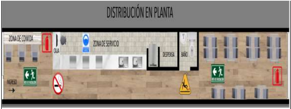
Ilustración 23. Señalización y ruta de evacuación.
