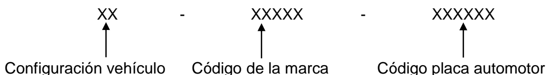
Figura 2. Codificación de equipos
