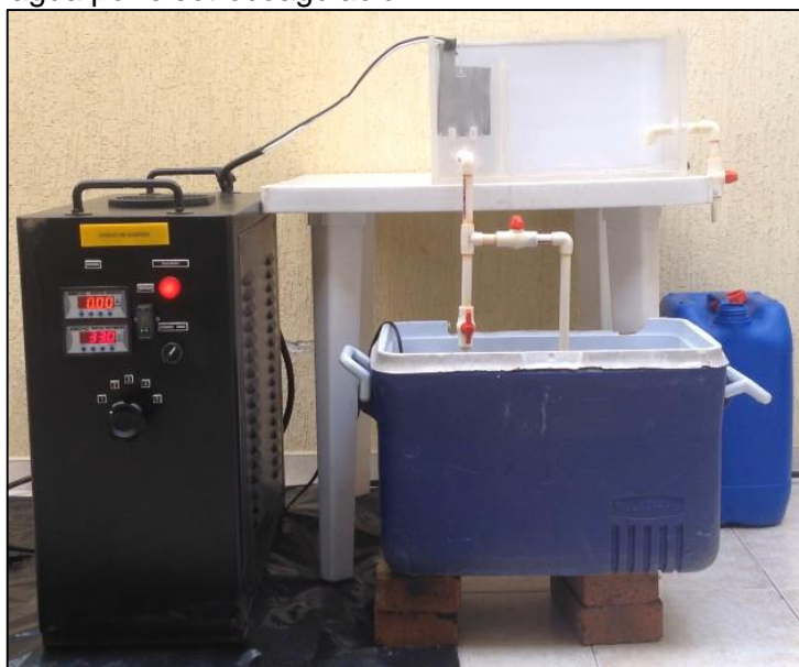
Figura 22. Montaje final para realizar tratamiento de agua por electrocoagulación.
