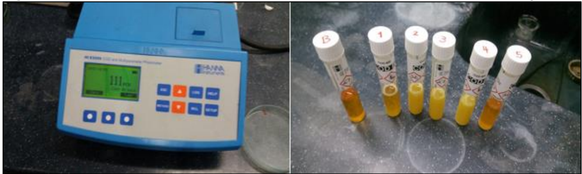
Figura 24. Fotómetro multiparámetro de sobremesa HI83099 y kit de reactivos rango alto.
