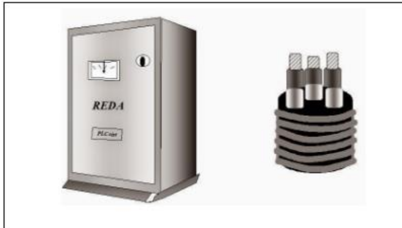
Figura 11. Cable de potencia.
