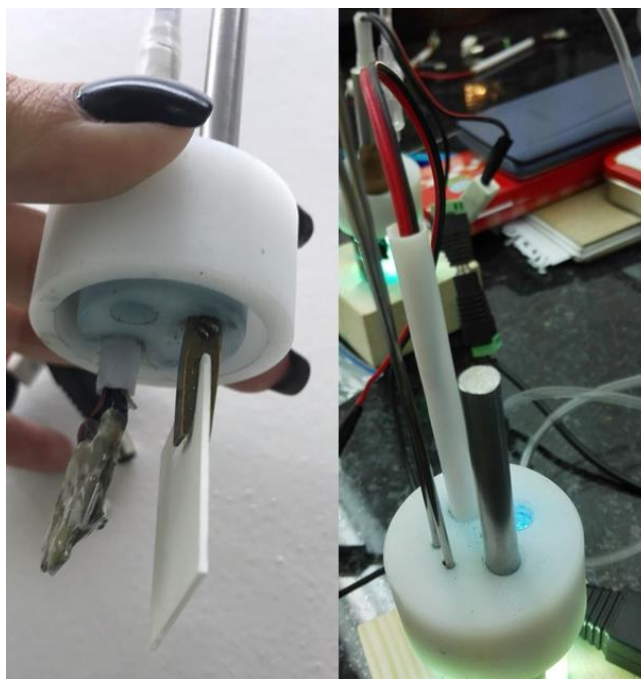
Figura 16. Vista inferior y superior de la tapa del reactor
