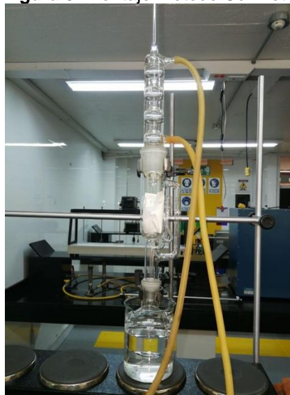
Figura 5. Montaje método Soxhlet.
