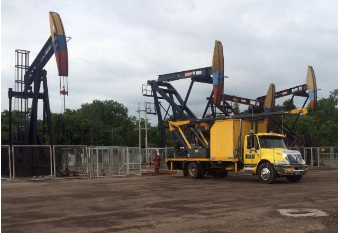
Figura 16. Camión con unidad de Slickline
