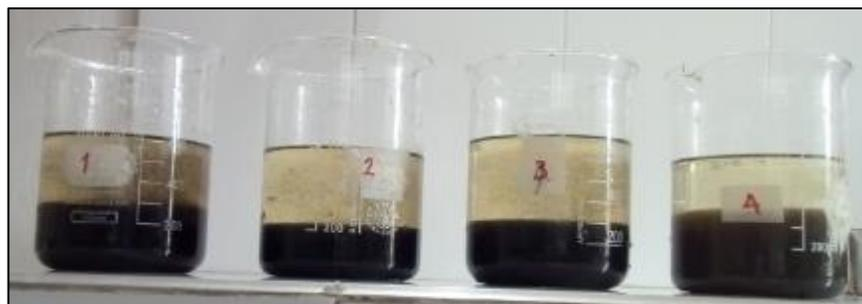
En este ensayo en general todas las jarras presentaron una alta remoción de turbidez y de sólidos suspendidos totales, aunque hubo una alta generación de lodo se estima que el volumen de lodo generado esta entre el 40% y el 50% del volumen de agua tratada en cada jarra adicionalmente se observó que la sedimentación fue demasiado lenta, en cuanto a la demanda química de oxígeno se evidencia una mayor remoción en la jarra 3.
