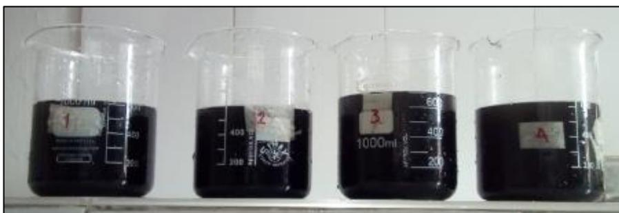
**Ensayo 1. Selección de concentración de policloruro de aluminio.** La Imagen 2 y en la Tabla 12 se presentan los resultados después del test de jarras usando policloruro de aluminio, en la jarra 1 y 2 hay formación de floc pero estos precipitaron demasiado lento con respecto a la jarra 3 donde se evidencia que usando una
