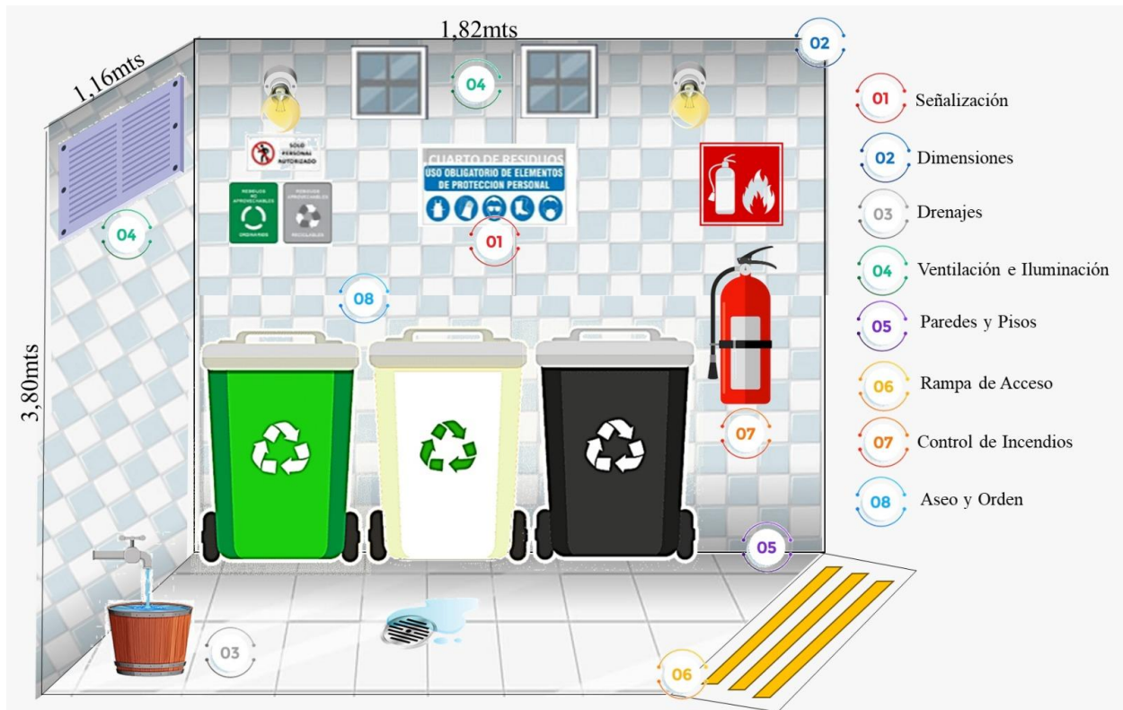
Figura 8. Cuarto de almacenamiento con lineamientos normativos
