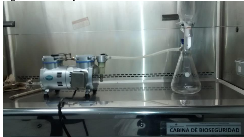
Figura 13. Montaje de filtración al vacío.
