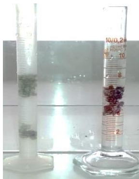
Imagen 9. Prueba de densidad muestra M2 y M3
