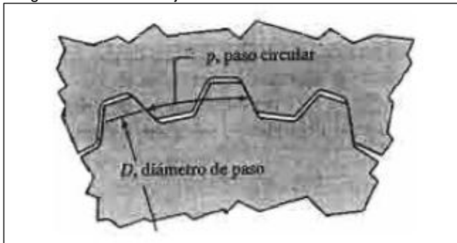
Imagen 62. Estría con ajuste lateral
