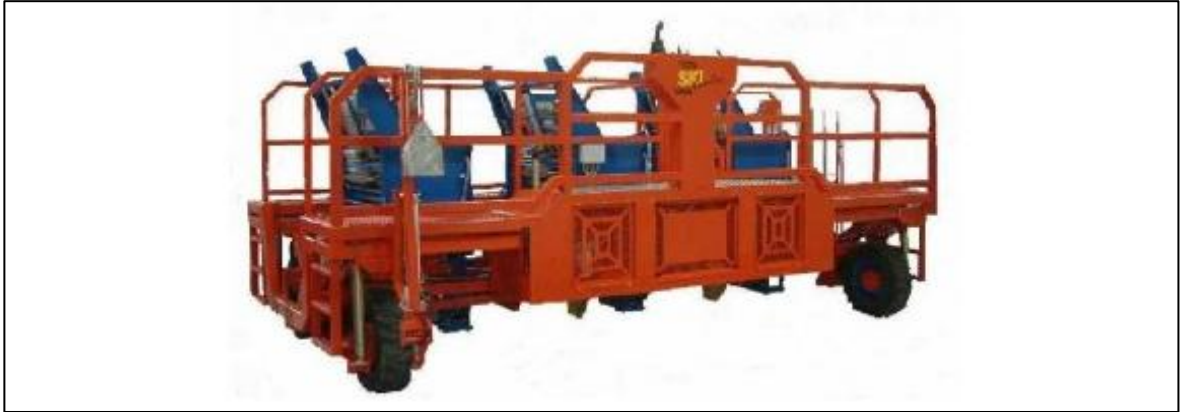
Imagen 12. Plantadora de árboles y clavadora de tutores. Derromero
