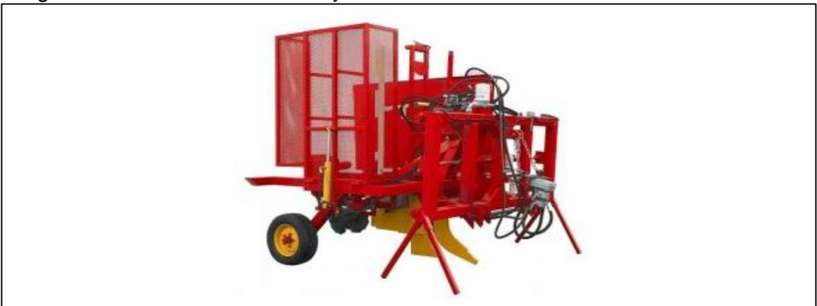
Imagen 11. Plantadora de árboles y clavadora de tutores. Derromero
