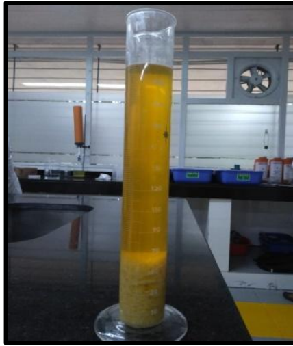
Imagen 14. Volumen de lodos generados durante la clarificación
