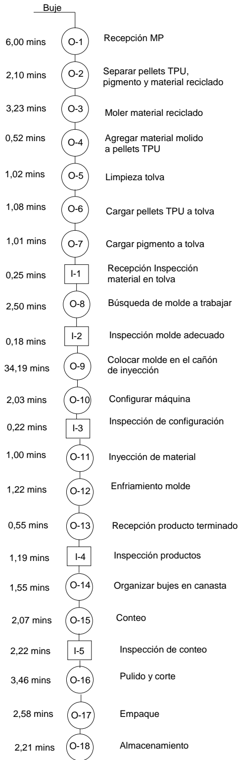
Diagrama 2. Diagrama de operaciones actual de buje para barra estabilizadora D-MAX 4x4.
