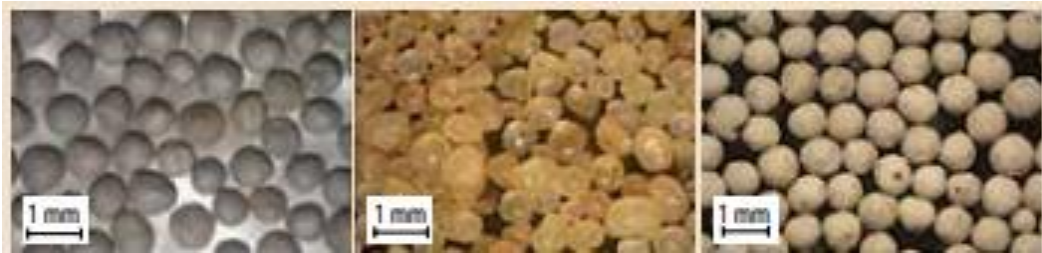
Figura 11 Material apuntalante. Diferentes tipos utilizados como: Bauxita de alta resistencia (1), sílice recubierto (2) y ceramica (3)
