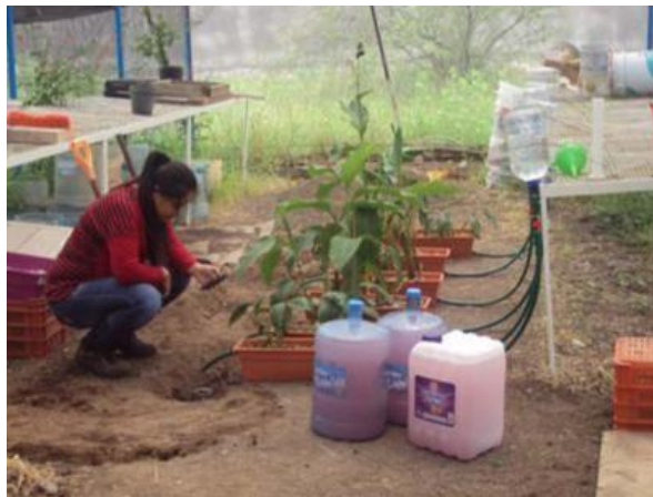
Figura 17. Adición de agua industrial a humedales experimentales
