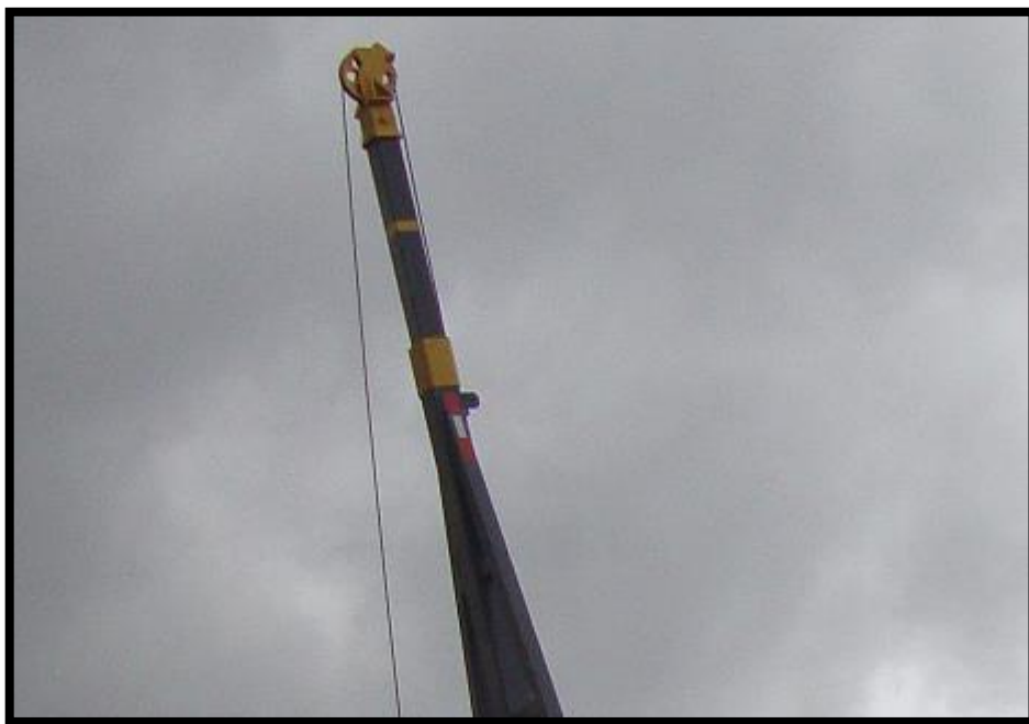
Foto 15. Polea unida al Boom del mástil de la unidad TSS003.
