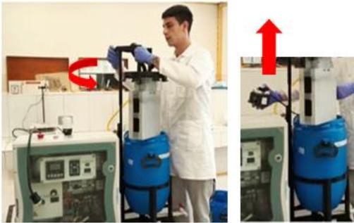
3. Gire los electrodos para que queden de lado permitiendo el acceso al interior del tanque de proceso, no olvide asegurar el tornillo, saque la bomba sumergible del tanque
