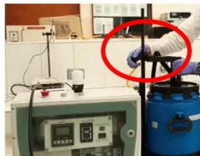
2. Desenrosque el tornillo de seguridad y eleve los electrodos a la posición superior, asegurando nuevamente el tornillo de seguridad en la posición alta.
