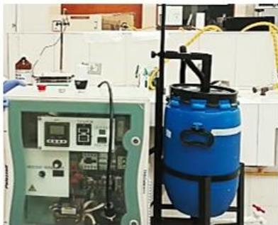
1. Asegúrese que el equipo se encuentra apagado, desconectado y limpio antes de iniciar las operaciones para la generación de hipoclorito de sodio.
