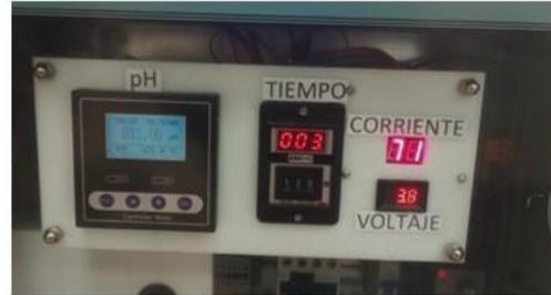
12. El equipo monitorea el pH, el tiempo de operación y muestra la información de corriente y voltaje
