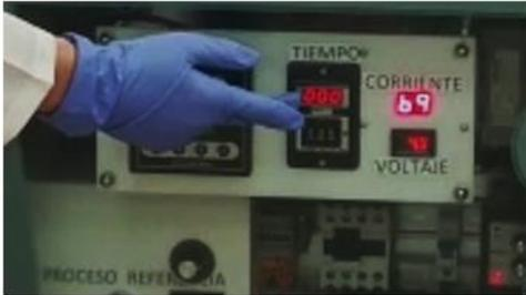
11. El sistema iniciará el conteo del tiempo de reacción en el tanque de proceso, cuando termina 120 minutos de ciclo, se activará una alarma sonora y lumínica que le avisará que la reacción ha terminado. El dispositivo se apagará al terminar el ciclo.
