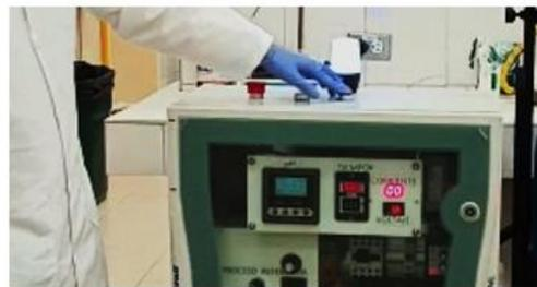
10. La programación permite una homogenización por 10 minutos posteriormente se apaga la bomba e inicia el proceso de electrolisis.
