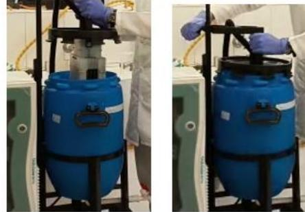
8. Baje los electrodos hasta el interior de la solución salina, asegure tornillo de seguridad en la posición baja y ponga la tapa sobre el tanque.
