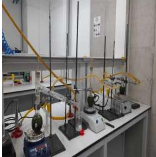
**Nota:** La figura muestra el montaje de la extracción por destilación simple antes del proceso de secado.
