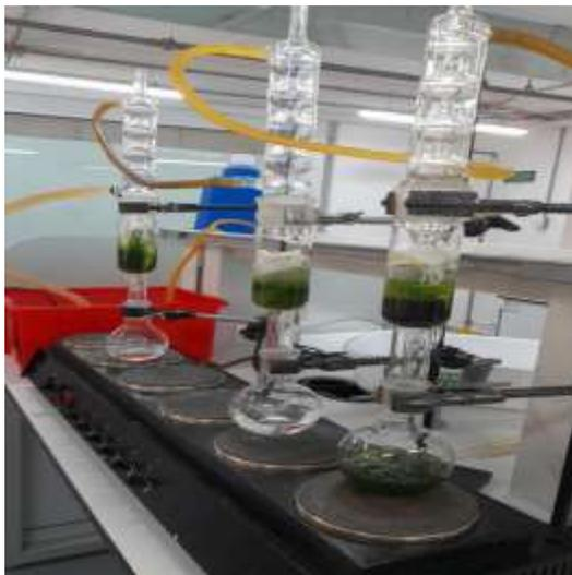
*Nota:* La figura muestra el montaje de la extracción por extracción Soxhlet.
