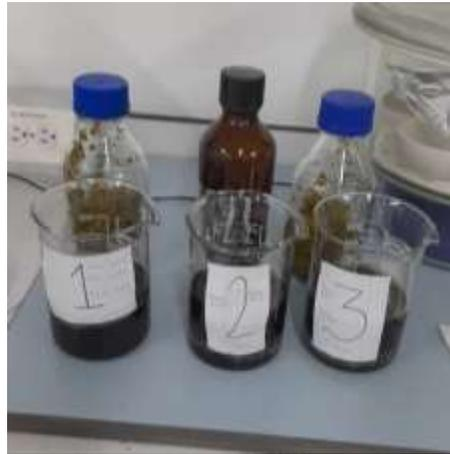
*Nota:* La figura muestra el resultado de la extracción por maceración en frío antes del proceso de secado.
