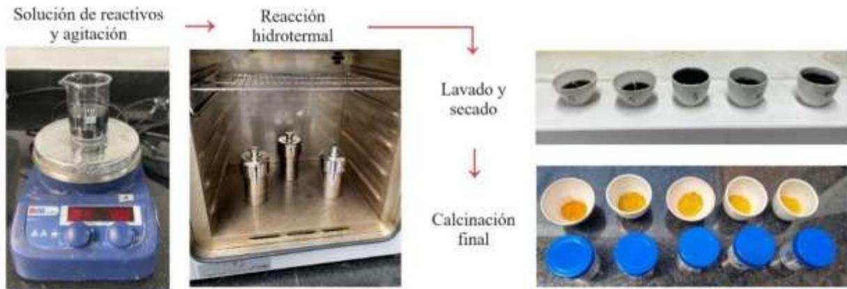
*Nota.* Experimentación para obtención de muestras por la técnica hidrotermal.
