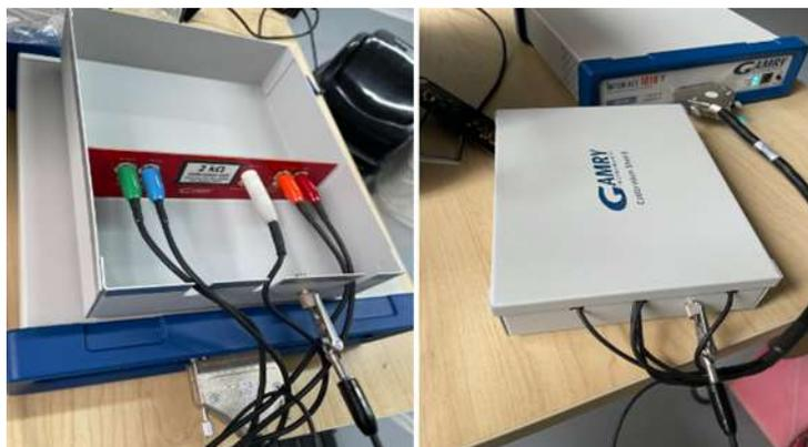
**Nota:** Se ve el montaje para la calibración de la celda con las conexiones respondientes
