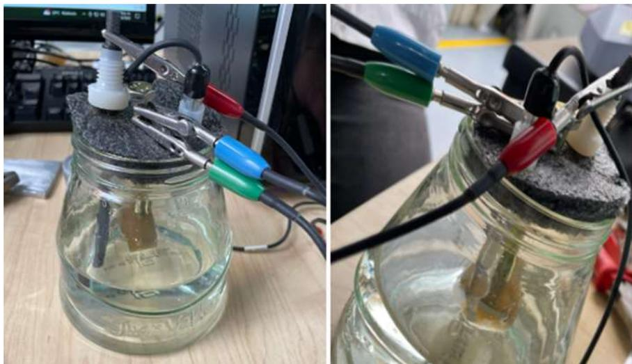
*Nota:* Muestra las conexiones que se hicieron para el ensayo potenciodinamico.
