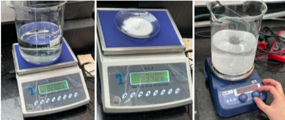
*Nota:* Muestra las cantidades utilizadas para formar la solución de 3.56% NaCl
