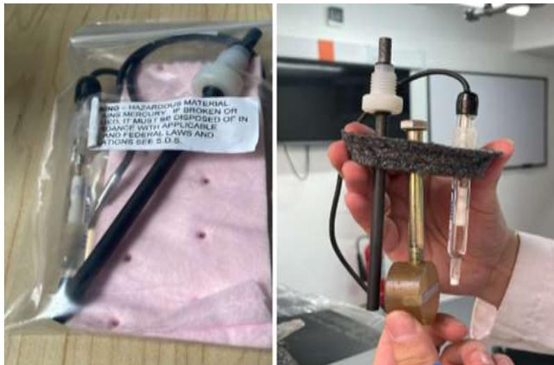
*Nota:* Muestra el grafito(contraelectrodo) y el electrodo de referencia junto a la manera de ensamblaje.
