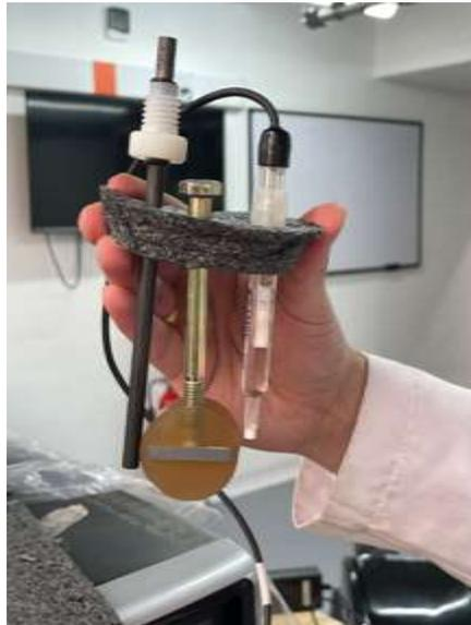
*Nota:* Muestra el grafito(contraelectrodo), la muestra ya ensamblada y el electrodo de referencia.
