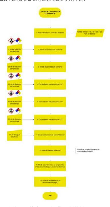
Nota. Diagrama de secuencia de preparación de curva de calibración del colorante
