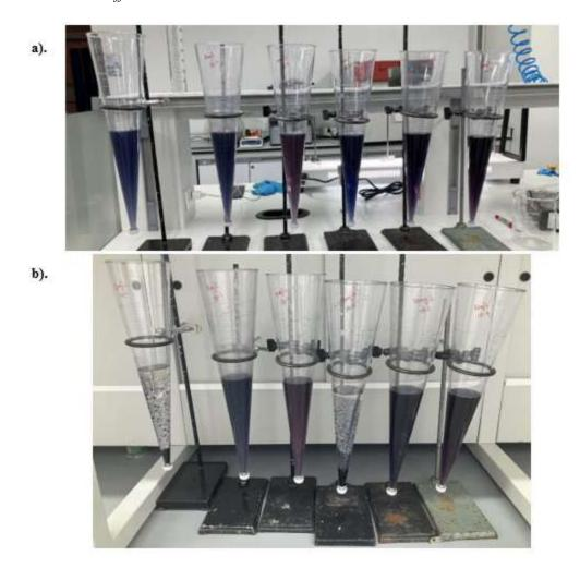
Nota. a). Conos Imhoff después de verter las jarras. b). Cono Imhoff después de 12 horas de sedimentación.
