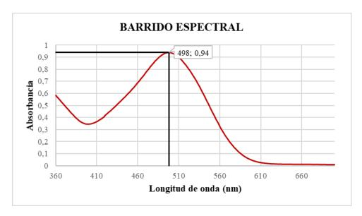
Nota. La Figura representa el barrido espectral realizado con una concentración de 15 mg/L de una solución de rojo Congo en un rango de 360 a 660 nm
