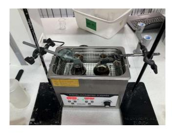
*Nota*. Montaje baño de ultrasonido a 40°C y 15 minutos para los experimentos 2 y 5.
