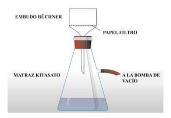
Nota. Montaje de filtración al vacío
