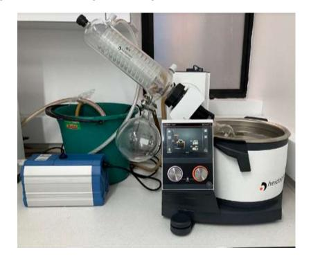
*Nota.* En el balón dentro del baño maría del equipo queda la muestra mientras que en el grande se recupera el etanol usado
