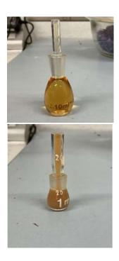
Nota. Se usa picnómetro de 10 ml para el extracto y picnómetro de 1 ml para extracto rotaevaporado.
