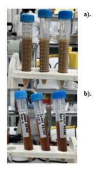
*Nota.* a). Muestra por triplicado antes de centrifugar. b). Muestra por triplicado después de centrifugar.
