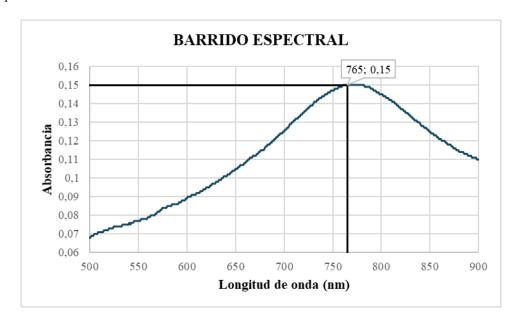
*Nota.* La Figura representa el barrido espectral realizado con una concentración de 60 mg/L en un rango de 500 a 960 nm.
