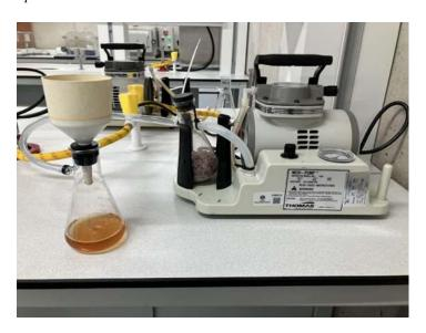
Nota. Se observa la separación sólido-líquido filtrando al vacío
