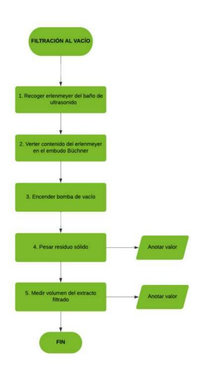
Nota. Diagrama de secuencia de filtración al vacío
