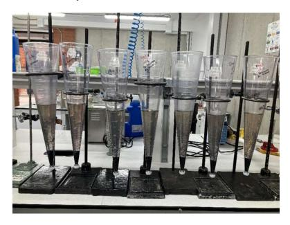
Nota. Conos Imhoff usando el diseño de experimentos.
