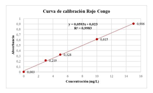
*Nota*. La Figura representa la curva de calibración con concentraciones de 2 a 13 mg/L de colorante rojo Congo, contando el blanco y obteniendo la ecuación de la recta.
