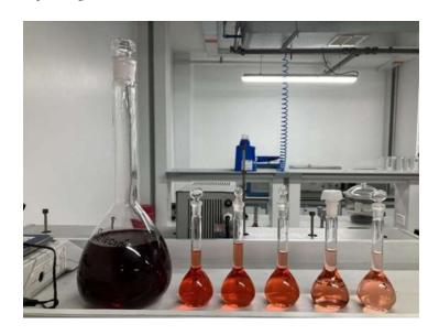
*Nota.* La Figura representa las diluciones realizadas para obtener la curva de calibración, con concentraciones de izquierda a derecha de 100, 17, 15, 10, 5 y 3 mg/L de colorante rojo Congo
