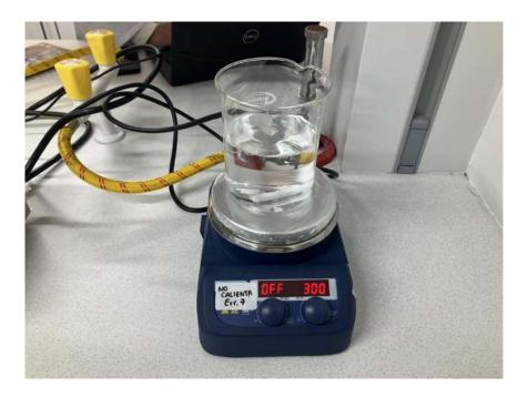
Nota. Preparación del solvente a 300 rpm por 1 minuto
