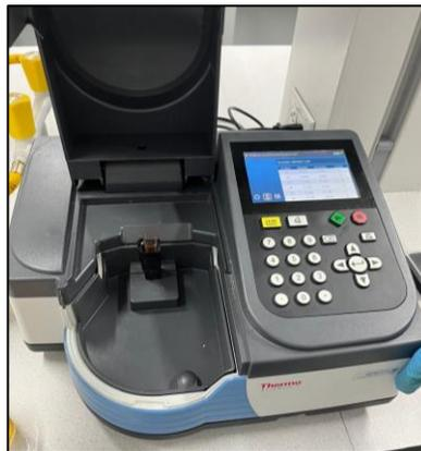
**Nota.** En la Figura se observan una de las muestras en el espectrofotómetro para medir su absorbancia.
