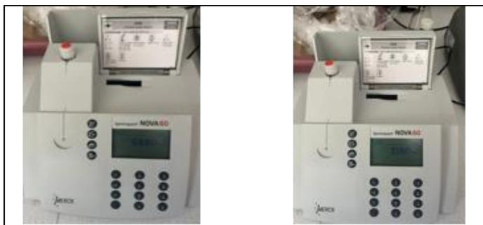
**Nota.** En la imagen se observa la lectura de DQO de las muestras 1:3 con ácido cítrico puro y 1:3 con ácido cítrico extraído de la cascara de naranja con el espectrofotómetro
