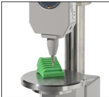
**Nota.** En la imagen se observa cómo se realiza el ensayo de dureza y el equipo que se requiere para llevar a cabo este. Tomado de [43] ISO, *Rubber, vulcanized or thermoplastic — Determination of hardness*. 2018. [Online]. Available: <https://www.iso.org/standard/74969.html>
