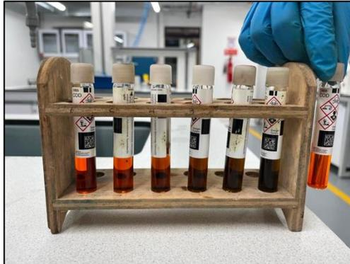
**Nota.** En la Figura se observan los tubos de DQO, cuando ya son sacados del termo reactor para que lleguen a temperatura ambiente.
