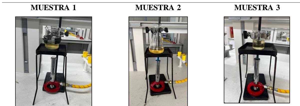
**Nota.** Las soluciones se calientan a 90°C para evaporar el agua y obtener el ácido cítrico que se encuentran en las distintas disoluciones.
