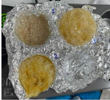
**Nota.** Se muestra como quedó el biopolímero de cada una de las muestras a partir de ácido cítrico puro y glicerol de la planta de biodiesel, realizado con una relación molar 1:1, 1:2 y 1:3.
