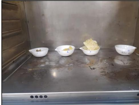
**Nota.** En esta imagen se observa cada una de las muestras en los crisoles dentro del horno a una temperatura de 110°C por 2 horas y 30 minutos, la muestra 1 es la muestra con una concentración 1:1, la muestra 2, es la de concentración 1:2, la muestra 3 es con concentración 1:3 y la muestra 4 es la que fue realizada a partir de ácido cítrico de la cascara de naranja el cual se encuentra a una concentración 1:3
