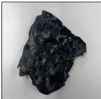
**Nota.** Se muestra el biopolímero resultante obtenido a partir de ácido cítrico extraído de la cascara de naranja y glicerol de la planta de biodiesel, realizado con una relación molar 1:3.
