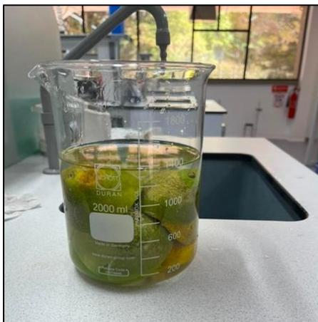
**Nota.** La cascara de naranja se desinfectó con una disolución de Hipoclorito de Sodio (NaClO) y agua destilada a una concentración de 0,1M, en un litro de agua destilada se le agregaba 1 mL de Hipoclorito de Sodio (NaClO)
