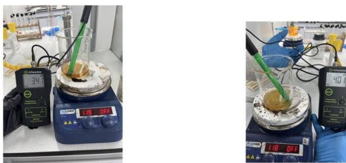
**Nota.** En la imagen se observa la lectura del potenciómetro a la solución determinando que al medir en determinadas ocasiones y la lectura sea la misma se establece que la reacción ya está en equilibrio.
