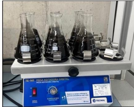
**Nota.** Disolución entre torta de micelio y agua desionizada con una relación 5:10 por cada 5 gramos de sustrato se agregan 100 mL de agua desionizada.
