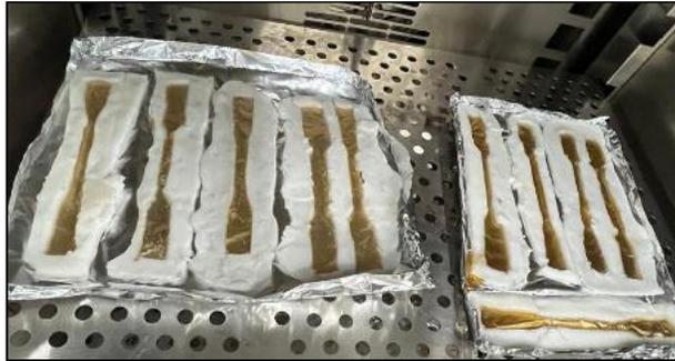
**Nota.** En la Figura se observan las probetas a partir del ácido cítrico y del glicerol.
