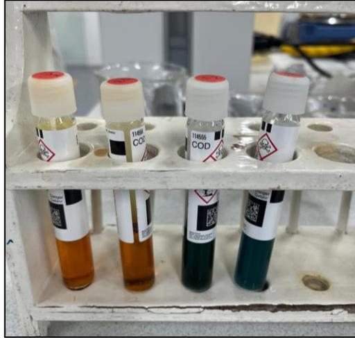
**Nota.** En la imagen se observan los 4 tubos con solución digestora y con 1 mL de cada una de las muestras del biopolímero.
