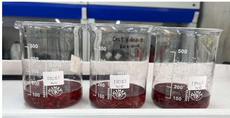
**Nota:** La figura muestra la extracción a las tres concentraciones del sustrato en caliente. Elaboración propia.
