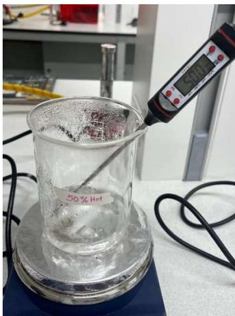
**Nota:** La figura muestra el solvente siendo elevado a una temperatura de 50° Celsius para ser agregado al sustrato. Elaboración propia
