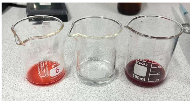
**Nota:** La figura muestra la dilución del sustrato para realizar la toma del espectrofotómetro. Elaboración propia.
