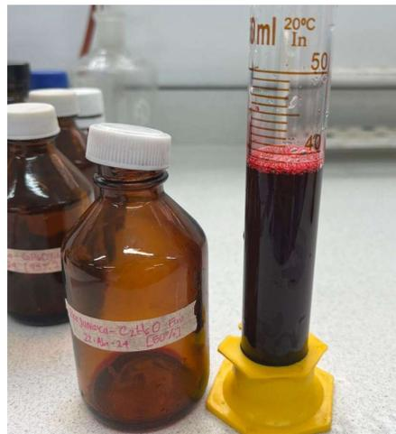
**Nota:** La figura muestra el sustrato luego de pasar por el rotaevaporador para retirar el solvente. Elaboración propia.
