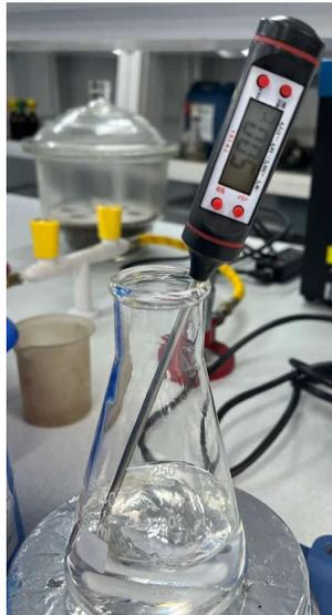
**Nota:** La figura muestra el solvente siendo elevado a una temperatura de 50° Celsius para ser agregado al sustrato. Elaboración propia.
