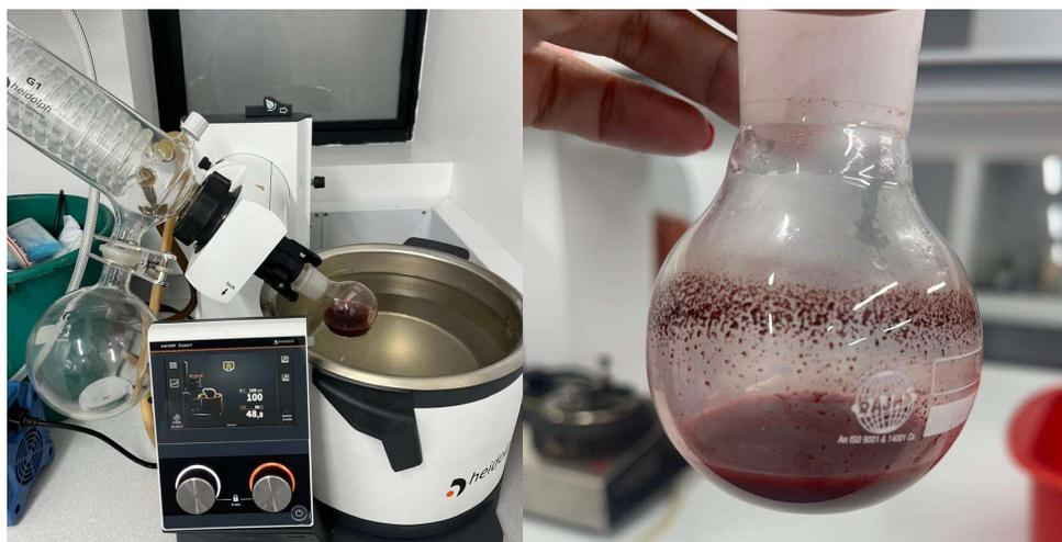
**Nota:** La figura muestra el sustrato en el rotaevaporador para retirar el solvente del sustrato. Elaboración propia.
