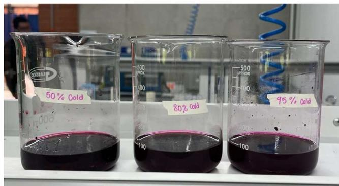
**Nota:** La figura muestra la extracción del sustrato a temperatura ambiente con sus tres concentraciones. Elaboración propia.
