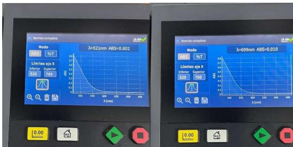
**Nota:** La figura muestra las curvas de absorbancia de la muestra a 520 nanómetros y 700 nanómetros según la norma empleada. Elaboración propia.
