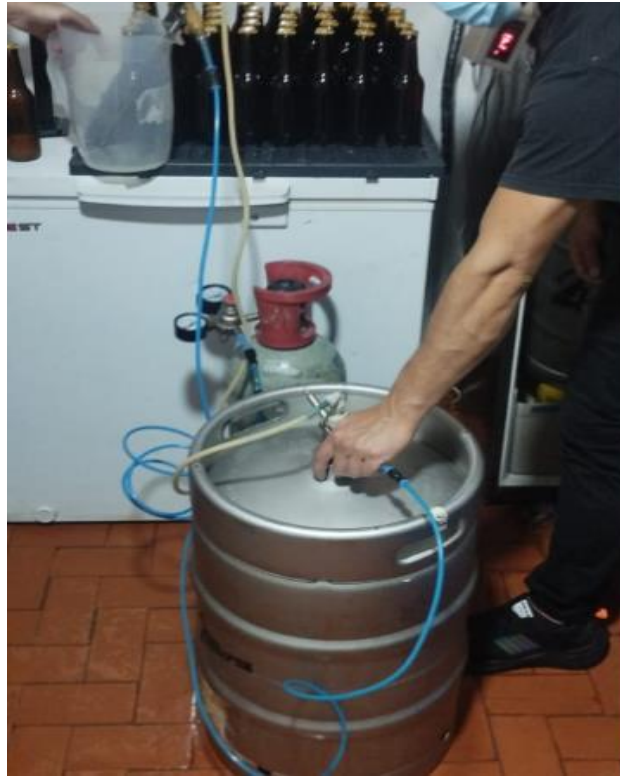
Montaje de adición de CO 2
