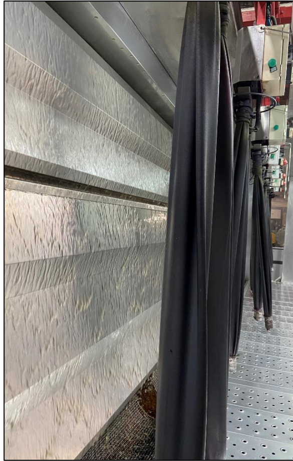
Nota: Cortina de agua ubicada en la parte trasera de la zona de aplicación para evitar dispersión del permanganato de potasio aplicado por aerografía
