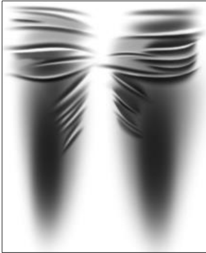
Figura 23 Diseño para marcación láser de usados y bigotes
