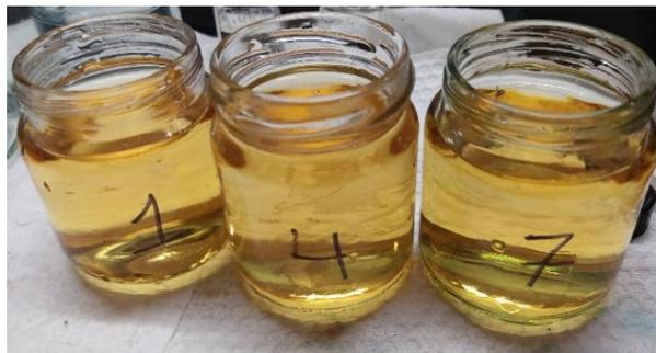
**Nota:** Las muestras evidenciadas fueron retiradas de sus respectivas fuentes de calor al completarse 30 minutos; las muestras N° 1, 4 y 7, se encontraban a 14 °C, 35 °C y 50 °C, respectivamente.
