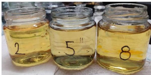
**Nota:** Las muestras evidenciadas fueron retiradas de sus respectivas fuentes de calor al completarse 30 minutos; las muestras N° 2, 5 y 8, se encontraban a 14 °C, 35 °C y 50 °C, respectivamente.
