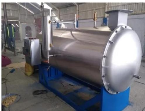
*Nota:* Representación gráfica de equipo para calentar mezcla de agua residual y cabello en proceso de Adsorción. Tomado de Smi Sur S.R.L., «Calentadores de Paso de Agua,» [En línea]. Available: <https://calderasindustrialesperu.com/productos/calentadores-de-paso-de-agua/>. [Último acceso: Noviembre 2022].
