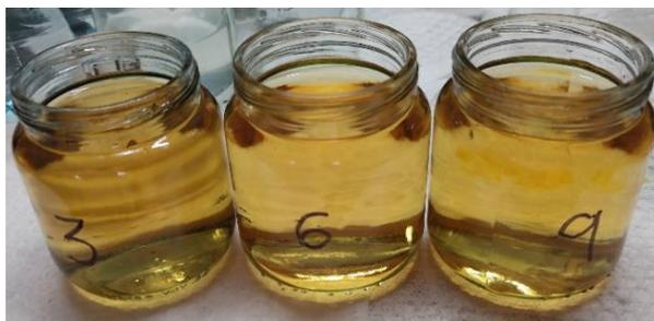
*Nota: Las muestras evidenciadas fueron retiradas de sus respectivas fuentes de calor al completarse 30 minutos; las muestras N° 3, 6 y 9, se encontraban a 14 °C, 35 °C y 50 °C, respectivamente.*
