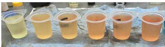
**Nota:** Las muestras resultantes corresponden, de izquierda a derecha, a las concentraciones de 0 mg/L; 0,1 mg/L; 0,2 mg/L; 0,3 mg/L; 0,4 mg/L y 0,5 mg/L.
