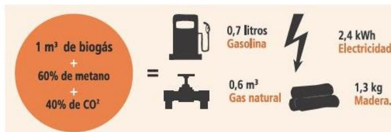
**Nota.** la figura 1 muestra la equivalencia del valor energético del biogás Tomado de: Red agrícola, (2017). Biogás. <https://www.redagricola.com/cl/lo-basico-entender-biogas>
