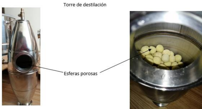
Torre de destilado del hidro-destilador
