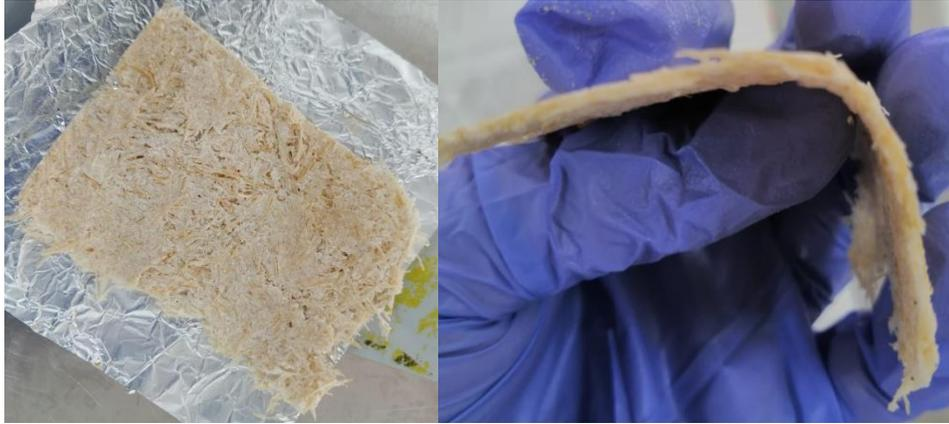
**Nota.** Mejoras tanto en flexibilidad como en porosidad ya que se reduce. A la izquierda se observa el filtro secado una vez se hizo la doble capa y la adición de los otros compuestos y a la derecha se observa la facilidad al doblar el medio filtrante.
