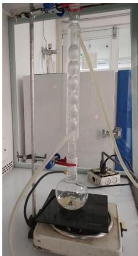
*Nota.* Montaje en las instalaciones del Tecnoparque, usando el chiller a temperatura de 3°C como refrigeración del condensador, manteniendo temperatura constante en cámara de extracción.
