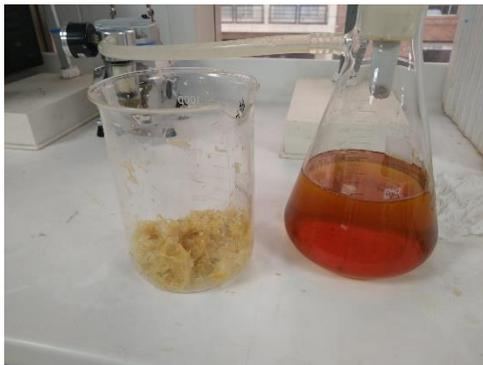
*Nota.* Debido al ataque alcalino se empieza a evidenciar una importante variación de color en donde el contacto con la materia prima genera la oxidación de la lignina dando el tono café oscuro característico del licor negro.
