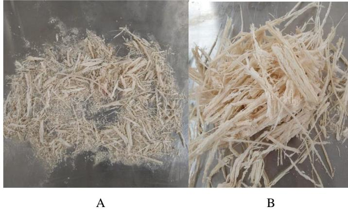
**Nota.** Cuando se hace la separación de las fibras a utilizar, este procedimiento genera un polvillo residual (A), el cual se asemeja con la medula seca aumentando la eficiencia del proceso, separado del bagazo integral (B).
