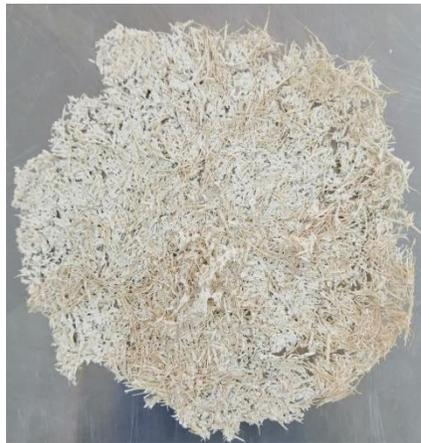
**Nota.** Se demuestra una lámina con un peso de  $4,0 \pm 0,5$  g de fibras de celulosa secadas por 22h aproximadamente a  $50^{\circ}\text{C}$
