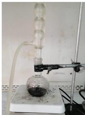
*Nota.* Montaje de porcentaje de lignina presente en las fibras, al 72 % v/v de H<sub>2</sub>SO<sub>4</sub> durante 2h y en cámara de extracción para evitar volátiles al diluir la solución al 5% v/v.
