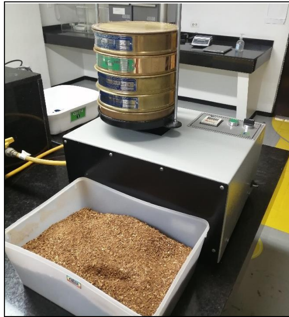
Figura 22. Proceso de tamizado
