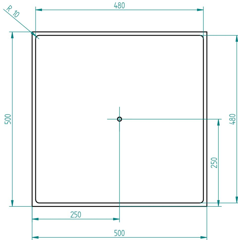
Este será construido por medio de láminas de aluminio y sus caras unidas por medio de soldadura por electrodos de aluminio Imell.
