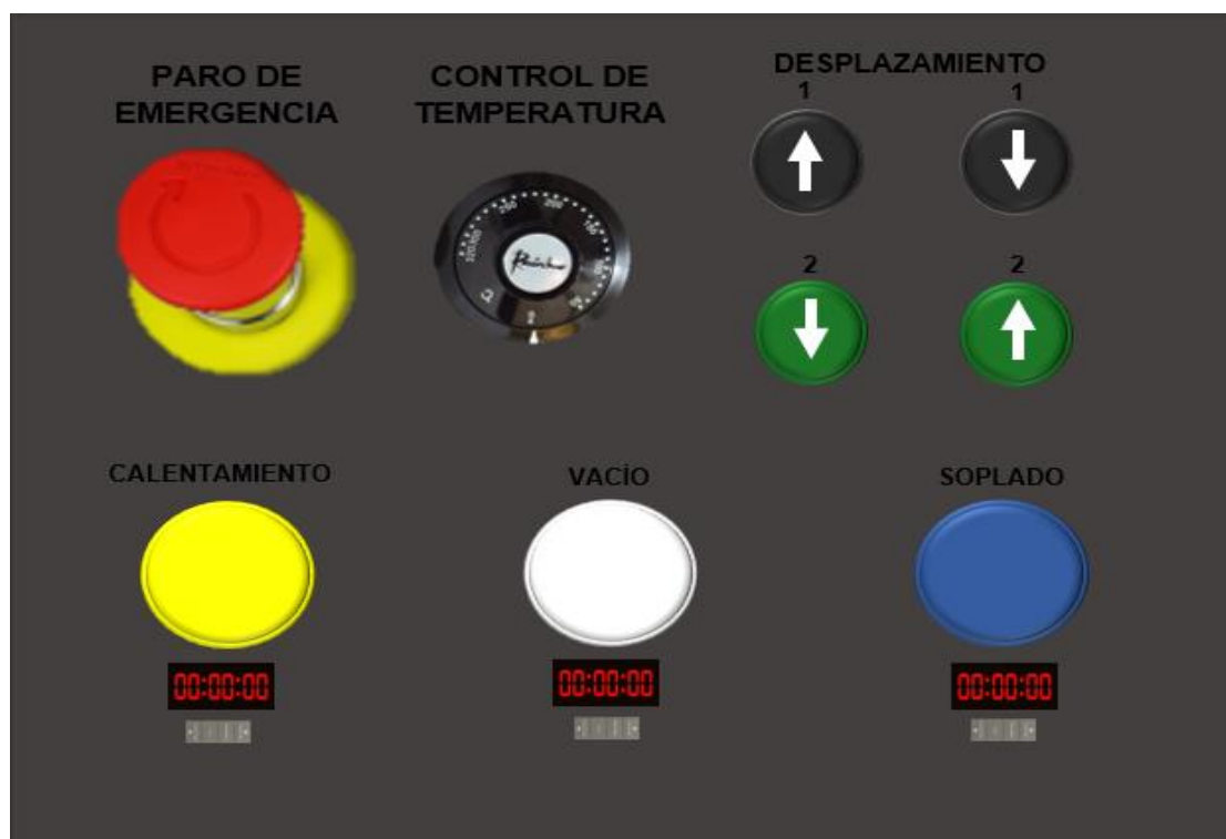
Panel de control de máquina de termoformado.
