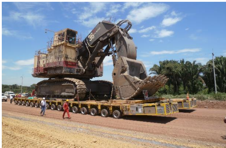
Figura 87. Movilización de pala Komatsu de 800 Ton
