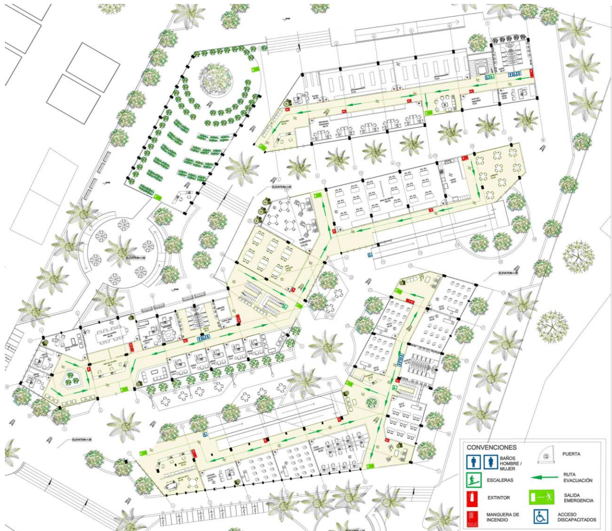
Planta de evacuación primer nivel
