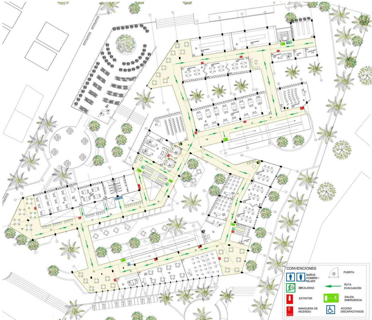
Planta de evacuación segundo nivel
