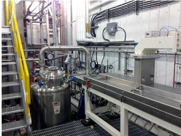
**Nota.** La imagen representa un equipo de infusión asistida por microondas para uso industrial. Tomado de: Sairem microondas y radiofrecuencias. Extracción de compuestos asistida por microondas. <https://www.sairem.com/es/solutions-for-food-and-industry/microwave-assisted-compound-extraction/>
