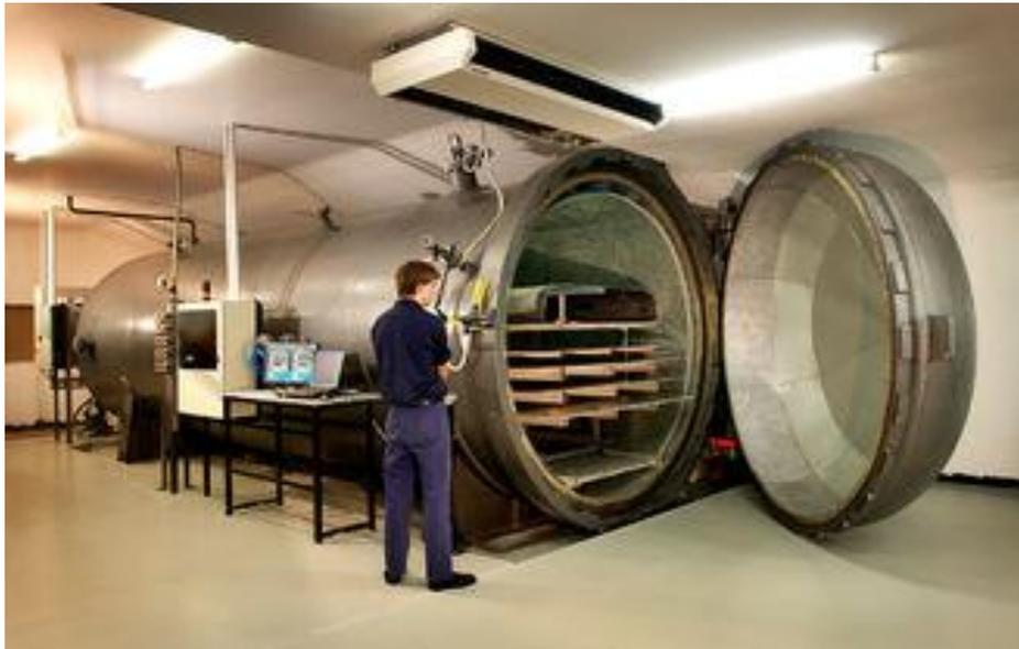
**Nota.** La figura muestra el equipo de una autoclave de uso industrial. Tomado de: Olymspan. Autoclave industrial del caucho/madera del equipo en grande del vapor  $\Phi$ 1.65m. <http://spanish.aac-autoclave.com/sale-1000050-rubber-wood-industrial-autoclave-of-large-scale-steam-equipment-1-65m.html>
