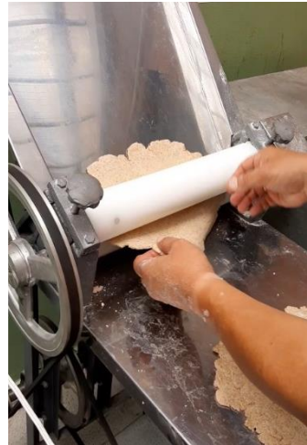
Figura 8. Cilindradora de la empresa Cookie Pets & Co.
