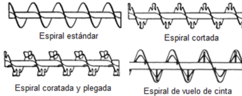
Figura 28. Clases de espirales del tornillo sin-fin
