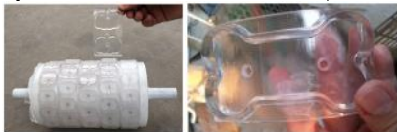
Figura 23. Molde de hueso en el rodillo rototroquelador
