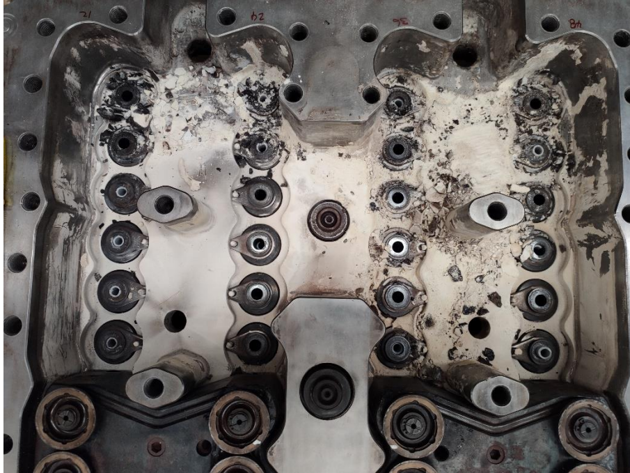
Figura 32. Material sobre inyectado y degradado en Hot Runner
