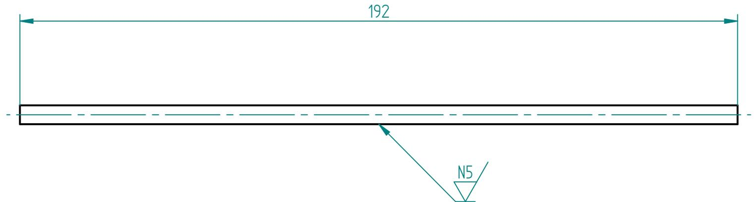
En el momento de su ensamble, esta pieza debe lubricarse por su ajuste de deslizamiento.
