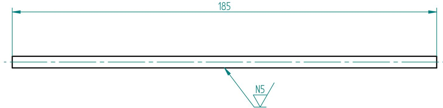
En el momento de su ensamble, esta pieza debe lubricarse por su ajuste de deslizamiento.
