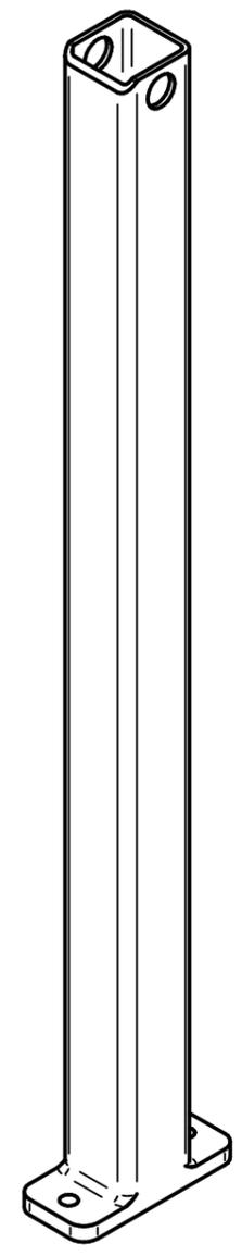
Completamente toda la viga 2 es de perfil hueco nominal 25 x 25 con espesor 1,778. Solo a excepción de las placas soldadas para sujeción.
