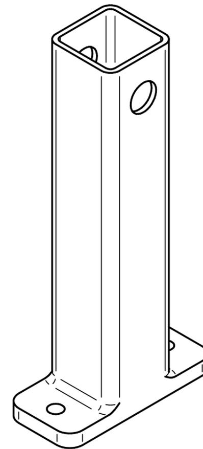
Completamente toda la viga 1 es de perfil hueco nominal 25 x 25 con espesor 1,778.
