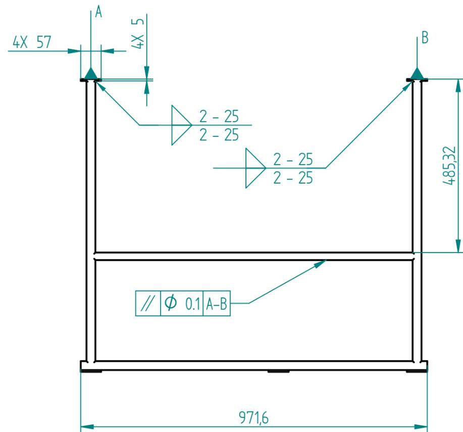
Completamente toda la mesa estructural está creada con vigas cuadradas huecas de perfil nominal 25 x 25, solo a excepción de las placas soldadas para sujeción.
