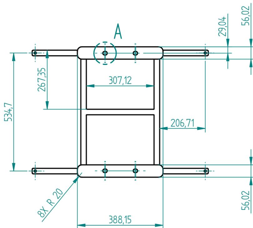
Completamente toda la mesa estructural de potencia está creada con vigas cuadradas huecas de perfil nominal 25 x 25, solo a excepción de las placas soldadas para sujeción.
