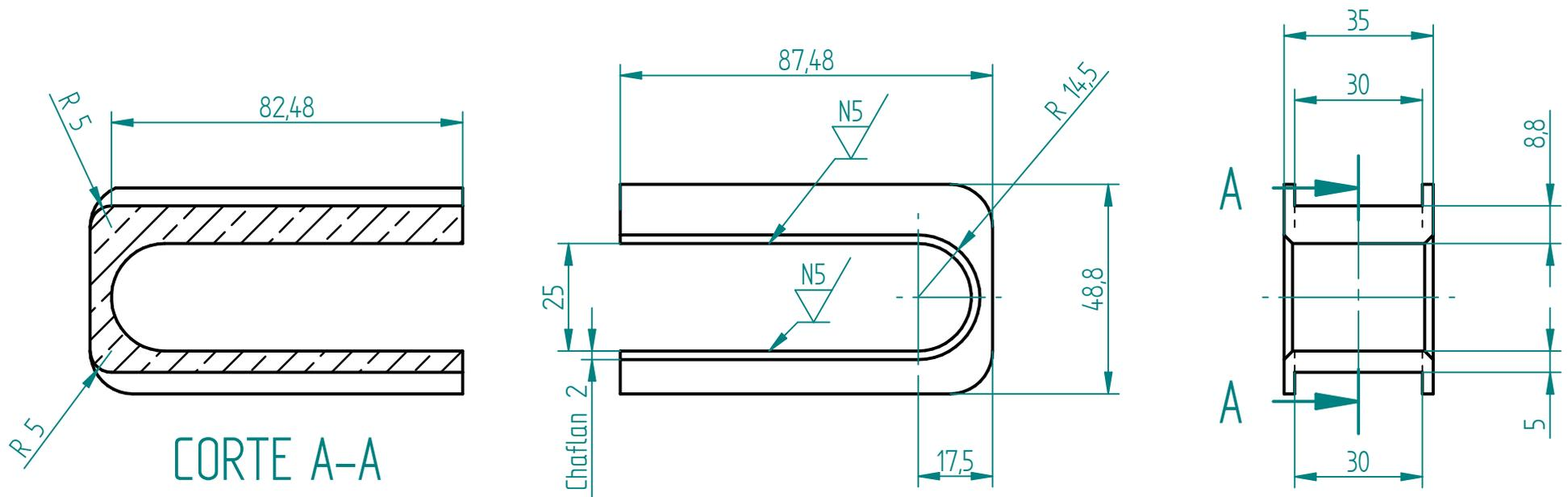
lubricar con SAE 140 sobre la superficie con la cota del acabado superficial nivel N5.
