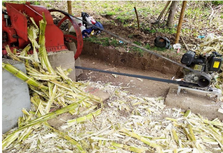
Nota. Figura de la transmisión de potencia entre un motor diésel de 8 caballos de fuerza y un trapiche tradicional.
